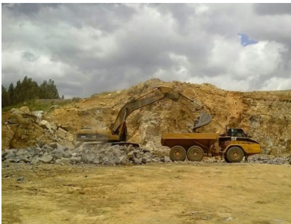
Figura 13. Equipos de minas a cielo abierto. a. Retroexcavadora cargando a un camión articulado; b. cargador frontal en frente de trabajo
