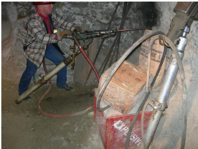
Figura 10. Trabajador minero con martillo neumático tipo jackleg
