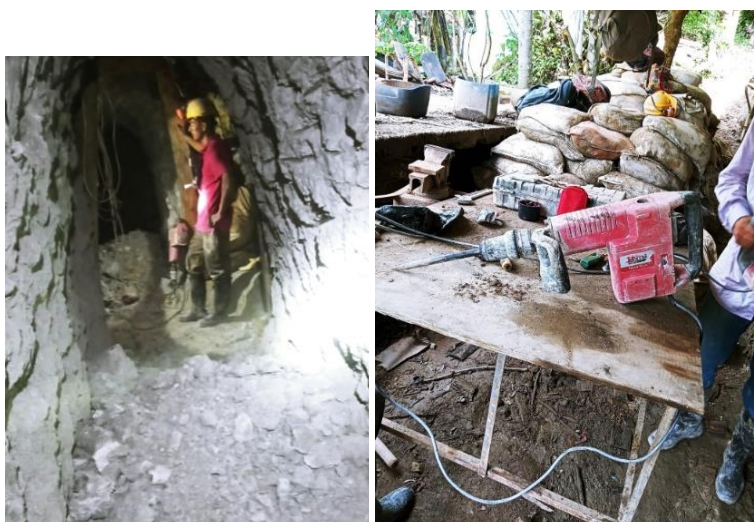
Figura 7. Equipo de minería subterránea. a. Trabajador con martillo eléctrico en frente y b. martillo en reparación.
