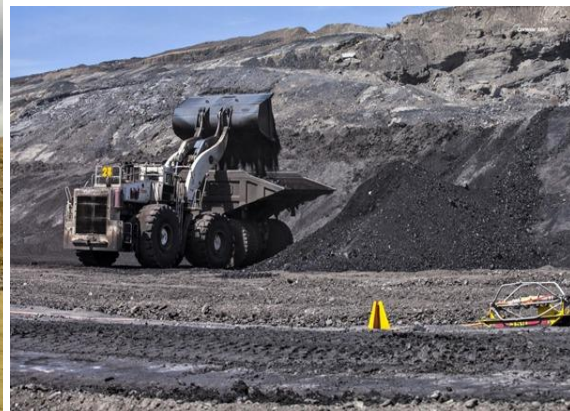
Figura 13. Equipos de minas a cielo abierto. a. Retroexcavadora cargando a un camión articulado; b. cargador frontal en frente de trabajo
